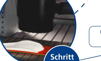
**Die CAD/CAM-**Konstruktion der Einlagen wird individuell nach den ermittelten Daten erstellt.
